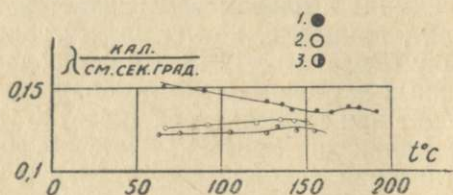
Рис. 6. Зависимость теплопроводности сплавов от температуры: 1 — олово, 2 — 1,91\% \text{Cd} + \text{Sn} ; 3 — 4,79\% \text{Cd} + \text{Sn} .
